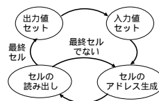
図 4 LUT カスケード・エミュレータの状態図
